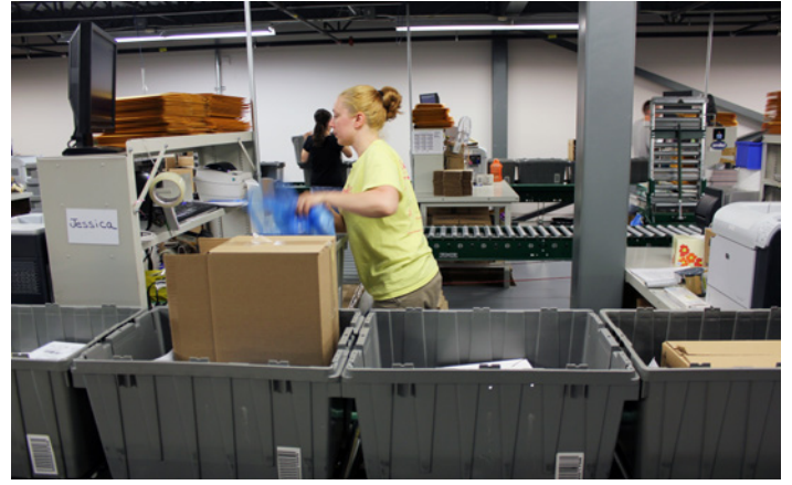
拣选站操作员将货物从料箱转移到装运纸箱
