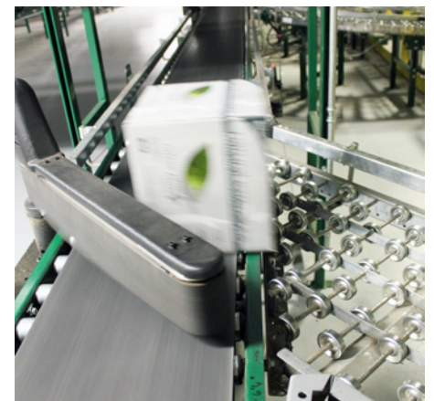
装运分拣机将纸箱转至适当的装运道口
