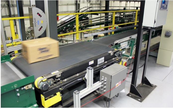
生产线嵌入式磅秤在装运前对各个纸箱进行称重检查
